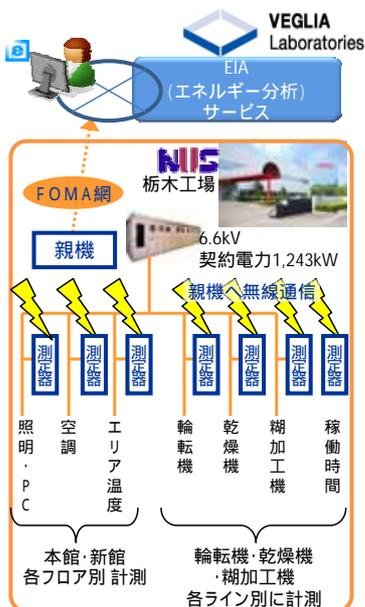
測定器101個を印刷機器に設置し、**デマンド電力**をリアルタイムに把握(見える化)
