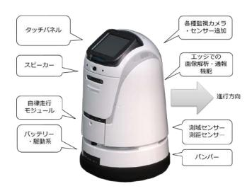
[サイズ] 高さ:1,015mm、幅:610mm、奥行き:680mm、重量:35kg、最高速度:6km/h ※共同研究開発中に、デザイン、機能、安全性を検討の上、適切な仕様に変更します。
