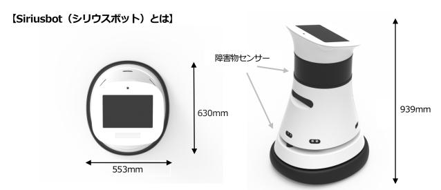
センサーが障害物を検知して、障害物のないルートを選択して走行します。 重さ:約35kg/走行速度:6km/h(最大)
