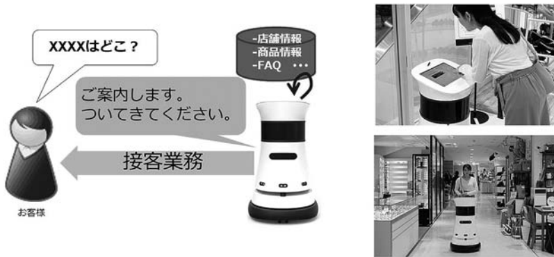
図7 小売店における接客ロボット
